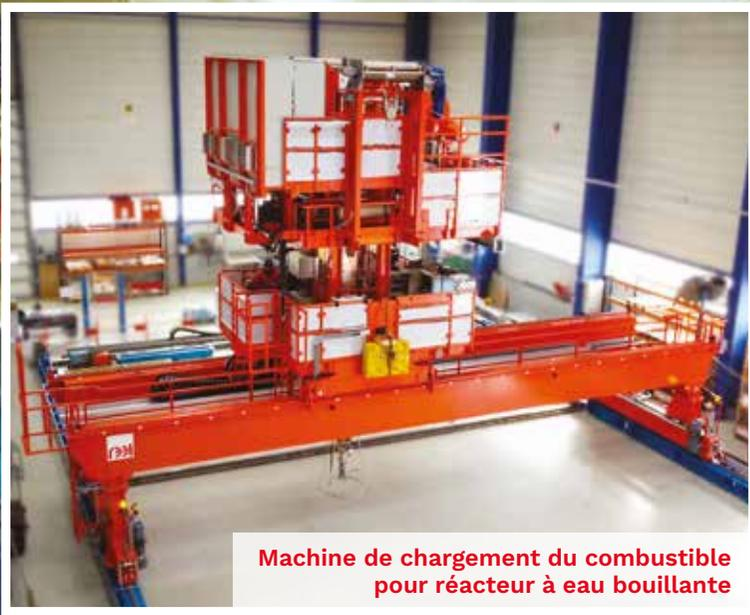
Machine de chargement du combustible pour réacteur à eau bouillante
