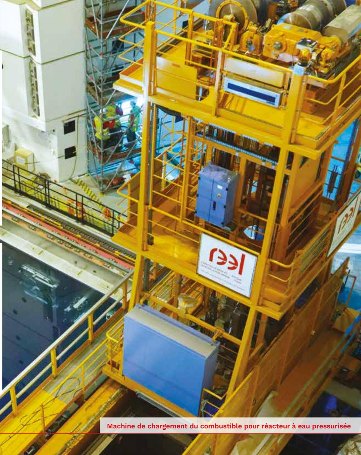
Machine de chargement du combustible pour réacteur à eau pressurisée
