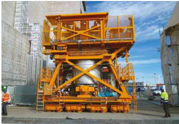
Système de déchargement du combustible usé (DMK)
