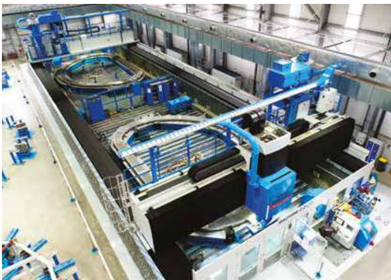
Plaques radiales pour le Tokamak ITER en cours d'usinage dans les ateliers CNIM Systèmes Industriels
