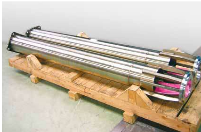
Internes de cuve : colonnes guides de grappes
