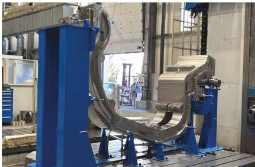
Cassettes de récupération du Tokamak ITER
