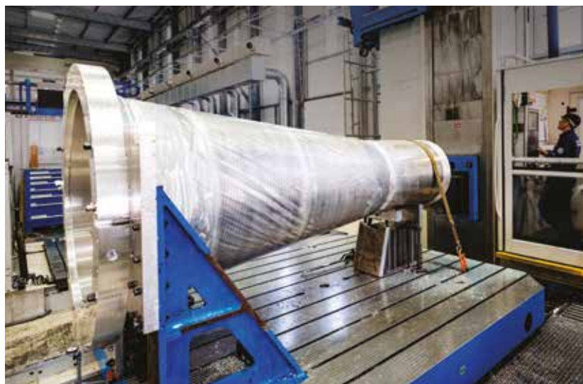
Doigt de gant pour le réacteur à haut flux de l'Institut Laue-Langevin
