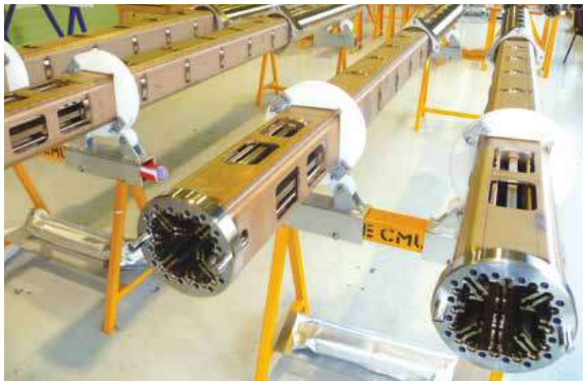
Internes de cuve : guides de grappes (CRGT)
