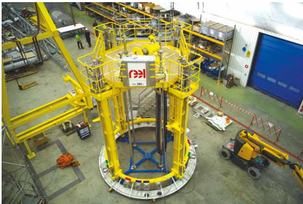
Outillage de manutention des internes
